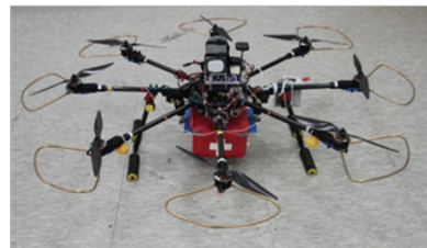
OctoUSR1 (택배용 드론) 8개의 프로펠러를 가진 옥토로터 타입으로 2kg payload를 가지며 20분 비행 가능한 기체이다. 기체 아래에 택배 운반용 손잡이 (gripper)를 부착하여 실외에서 무인으로 물품 배송이 가능하도록 개발하였다.
