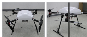
Long-Endurance for Rescue Gryphon Dynamics GD-X8 해상 구조 임무를 위해 개발중인 무인비행체로 비교적 긴 35분의 비행시간을 갖는다. 총중량 20kg의 대형 드론이며, 전장을 방수로 설계하여 해수면에서의 운용이 가능하도록 연구중에 있다.
